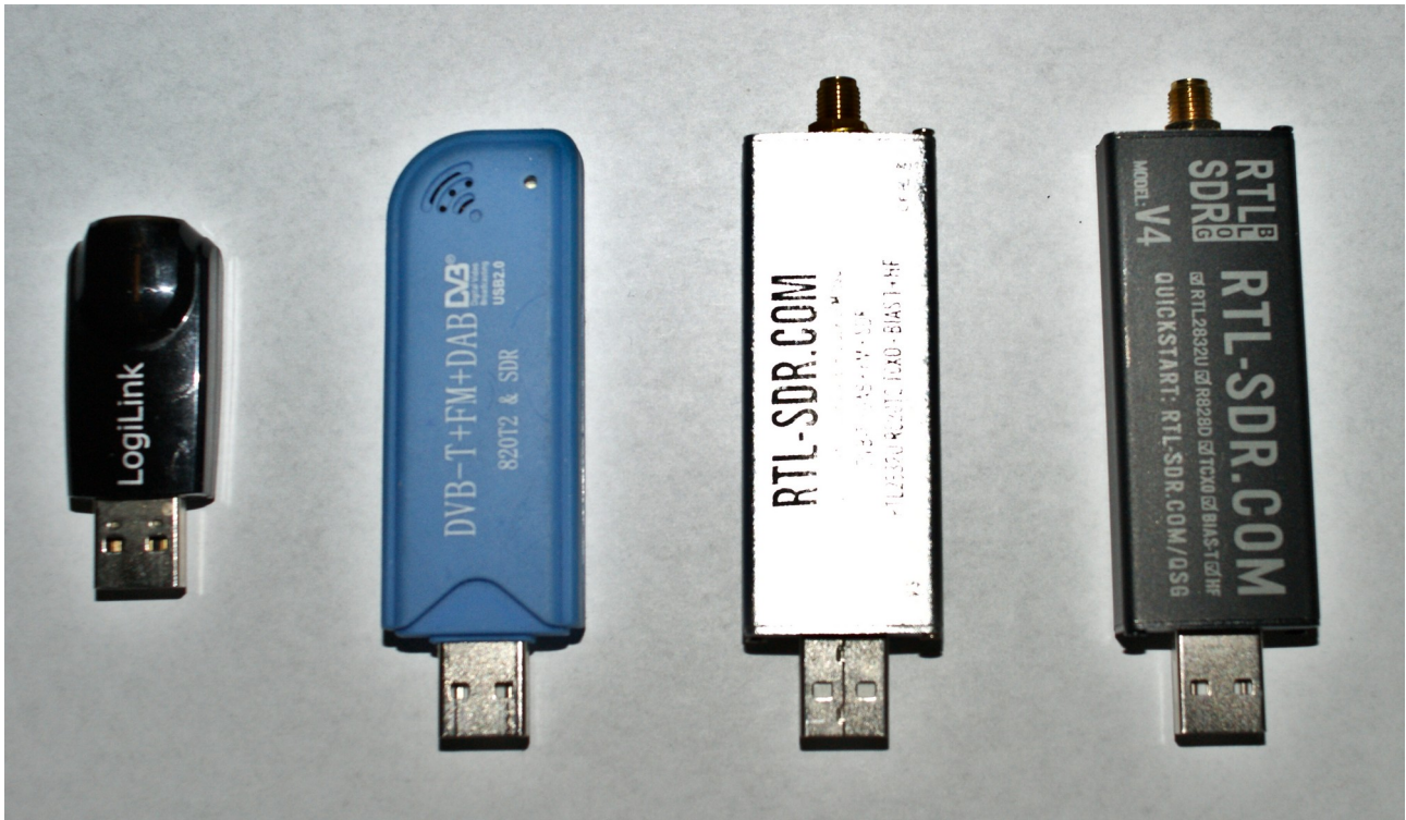
Schaubild 1: Verschiedene RTL-SDR-Sticks
