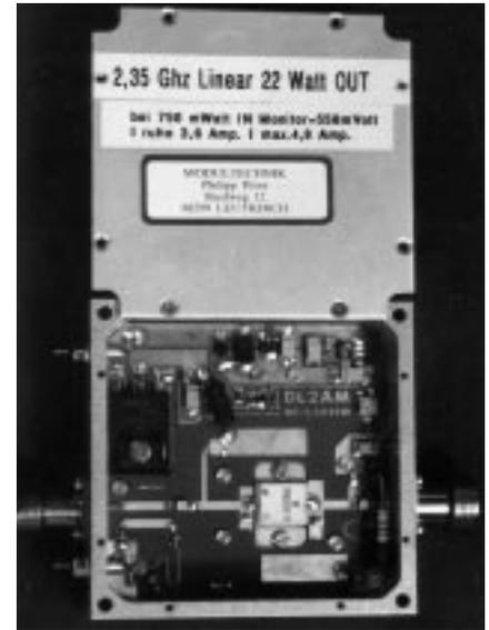
Gehäuse auf einen planen Kühlkörper zu schrauben, der einen K-Wert von min. 0,9° C/Watt hat. Zwischen Gehäuse und Kühlkörper ist Wärmeleitpaste aufzutra-
