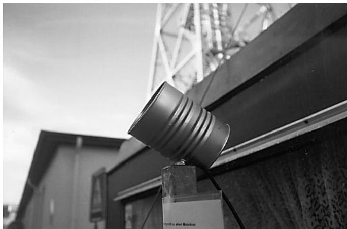
**Kanadische Maisdose als Strahler für 13 cm Sendeantenne zur Übertragung der Bilder aus dem Funkmobil zum DARC-Stand „handmade“ by DL7USC**
