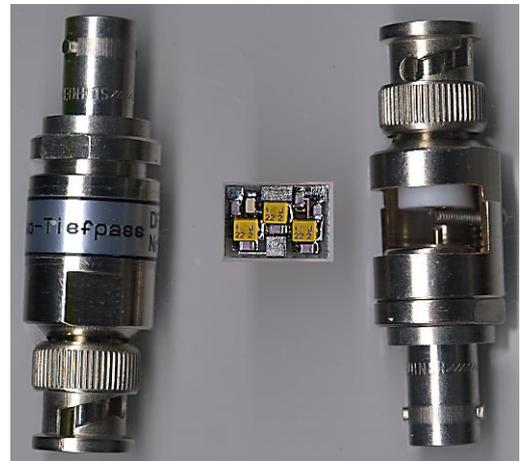
Der Tiefpaßfilter wird vor dem Sender in die Videoleitung eingeschleift. Bei Betrachtung des Bildes sollten sich keine nennenswerten Veränderungen zeigen. Ein Abgleich des Filters ist auf Grund der Bauteile nicht erforderlich. Bei der Berechnung der Filterflanke wurden entsprechende Bauteiletoleranzen berücksichtigt.
