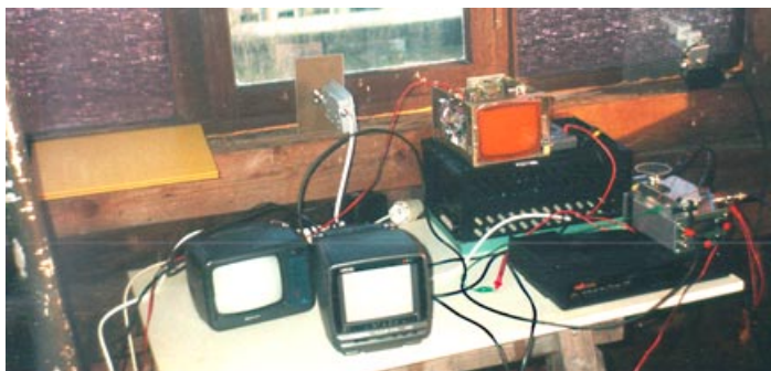
Einer von vier Tischen mit Technik, am Fenster der 13 cm-Konverter, mit dem ein Bild von DG6SXB empfangen wurde. Auf dem SAT - Empfänger ein von DL40V gebauter 23 cm-Empfänger nach DF4PN.
