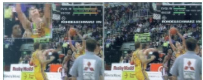
BILD 2 Deutlich sichtbare Blocking-Effekte an einem digital codierten Fernsehbild und - zum Vergleich - ohne Blocking mit eingblendeten Qualitätswerten nach SSCQ (subjektiv) und DVQL (objektiv). (siehe Farbdruck Titelseite)
