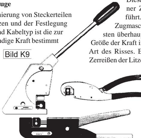
Eine kleine Aufbiegung der Zangenöffnung, vor allem bei kleinen Handzangen, läßt sich oft nicht verhindern, muß aber in kontrollierten Grenzen gehalten werden. Sie ist bereits in der Dimensionierung von Steckerteilen und Einsätzen zu berücksichtigen. Klemmzangen sollten für eine maximale Klemmkraft von 10000 kN bei 1,5 facher Sicherheit ausgelegt sein. Dies erfordert einen Einsatz hochfester Materialien für praktisch alle Elemente.
