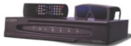
„C-3D Digital Converter“ zusammen mit den infrarotgesteuerten LCD-Shutterbrillen für jeden Zuschauer.
