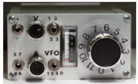
**Bild 5:** Empfänger im Isel (Euro) Gehäuse. Durch die Größe des Abstimmknopfes ist der Skalenweg und damit die Auflösung der Frequenzanzeige gestiegen. Die 10 MHz-Stelle der eingestellten Frequenz wird „digital“ angezeigt. Eine Abschätzung auf etwa 3 MHz ist gut möglich.
