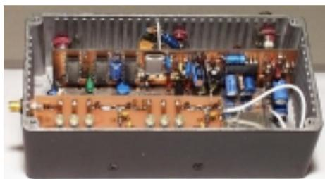
**Bild 2:** Innenansicht 23 cm-Empfänger für Festfrequenzbetrieb (z.B. Relais) mit zusätzlich ein-
