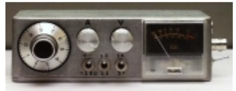
**Bild 3:** Frequenzvariabler Empfänger mit zusätzlich wählbarer durch Quarz stabilisierter Festfrequenz (1280 MHz). Der verwendete Abstimmknopf hat eine 2 MHz-Einteilung. Die Frequenz kann von 1230 MHz (3 auf der Skala) bis 1310 MHz (1 auf der Skala) eingestellt werden.
