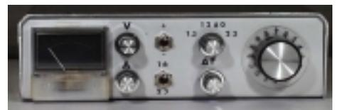
**Bild 4:** Empfänger im Teko-Gehäuse. Der verwendete Abstimmknopf bietet eine weniger genaue Frequenzauflösung. Dafür ist der Anzeigebereich größer. Außerdem können neben der quarzstabilen Festfrequenz weitere mit Spindelpoti eingestellte Festfrequenzen sofort ausgewählt werden und mit der Feinabstimmung optimiert werden.
