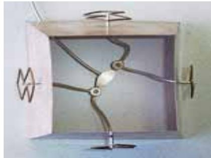
Grad Elevation) angebracht sind. Diese wurde aus 0,5 mm starkem LP-Material aufgebaut. Die Speisung der 4 Strahler
