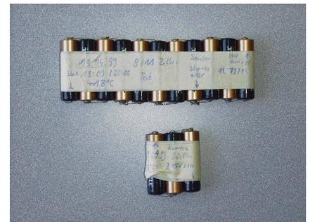
spannung von 0,6 V. Die Stromversorgung des Senders erfolgte aus 11 Mignon-Zellen. Dabei wurde der LO des Senders mit den ersten 8 Zellen über einen Step-Up-Regler versorgt. Die 13 cm-PA wurde wegen des recht hohen Stromverbrauches (rund 550 mA) aus allen 11 Zellen über einen Step-Down-Regler versorgt. Der Sender arbeitete bis zu einer Zellenspannung von 0,9 V. Die
