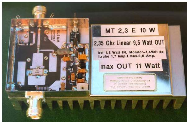
Weitere 40 verschiedene Linear-Verstärker, davon sind einige neu, von 1-10 GHz und 1-160 Watt out für SSB und FM-ATV als Bausatz und fertig aufgebaut gibts es noch, siehe TV-AMATEUR Heft 111, S. 15 und Web-Seite. Einige Linear`s sind inzwischen preisgünstiger geworden. Fragen Sie mal an!
