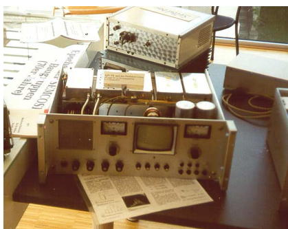
Ein perfekt von DJ9HI aufgebauter 70 cm ATV-Transceiver nach DJ4LB
