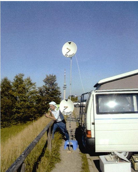
Vom Hohenpeissenberg (988 m) auf 10 GHz, zum ATV-Relais DBØIV (Augsburg) mit 48 cm-Spiegel, 2,5 W HF über 64 km
