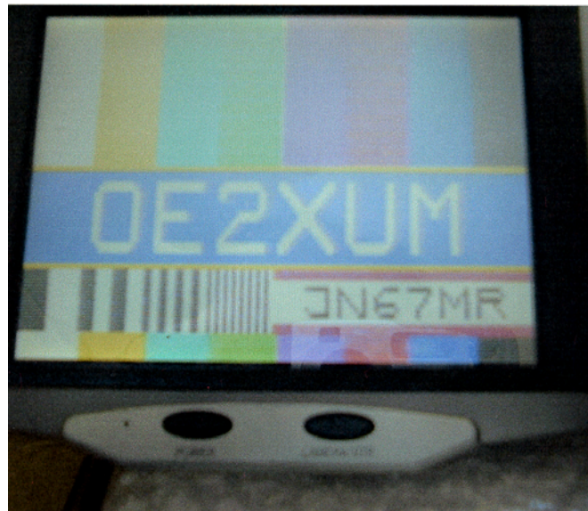
Empfang von OE2XUM (Untersberg) auf 10 GHz (52 km) mit 48 cm-Spiegel vom Urlaubs-QTH in OE5
