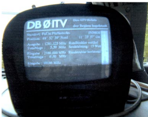
Empfang von DBØIV (Ingolstadt) auf 23 cm (102 km) mit 6-Element-Gruppenstrahler
