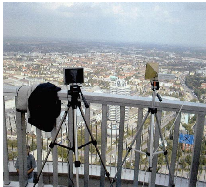
24 GHz-Empfangsversuche auf dem Münchener Fernsehsehturm mit 24 db-Horn, ATV-Konverter (Kuhne), SAT-Empfänger (12V) und 5,6" TFT-LCD-Farbmonitor
