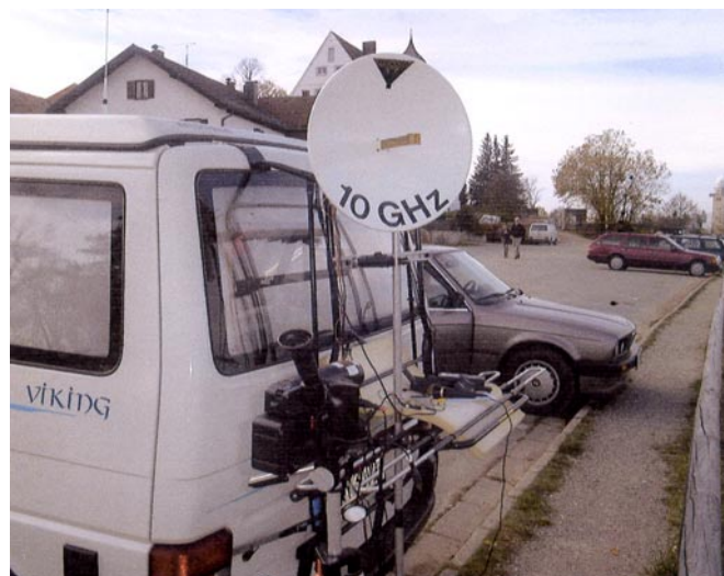
10 GHz-Direktverbindung DJ9PE/p (Hohenpeissenberg) und DC6WU (München-Nord) über 63 km ohne freie Sicht mit B4, 48 cm-Spiegel, 2,5 W HF
