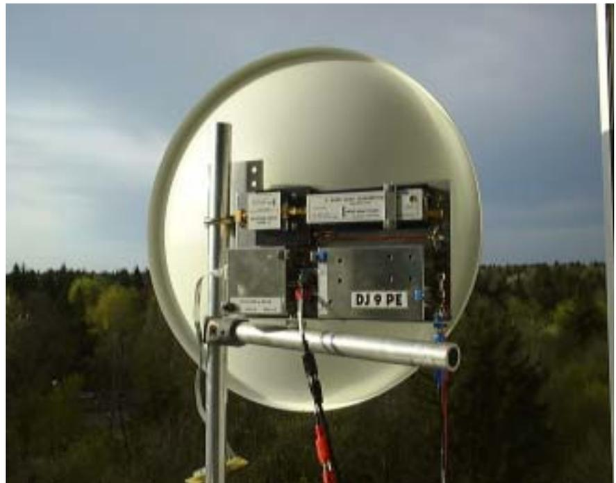
24 GHz-Sender mit Spiegel bei DJ9PE am Fenster
