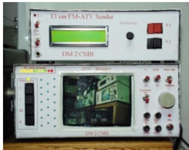
Geräteansicht; links: Tasten „ATV-Logo“; rechts: oben Signalumschaltung, unten Monitoranschlüsse
