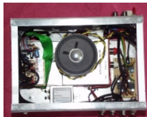
Gerät von unten. Links: Audiosignalaufbereitung, rechts: Videosignalaufbereitung jeweils auf Lochrasterplatinen.
