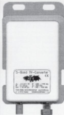
Der Konverter besitzt ein selektives Mikrostripfilter gegen Außerbandstörungen.
