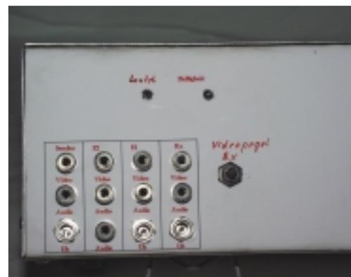
Geräterückseite mit den Signaleingängen sowie der Spannungsverteilung
