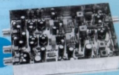
Die **PLL 30** arbeitet mit 8 wählbaren Abstimmritten bis zu einer maximalen Frequenz von 2900 MHz, beginnend bei 250 MHz. Die Frequenzschritte betragen: 100 KHz, 200 KHz, 500 KHz, 1 MHz, 2 MHz, 5 MHz, 10 MHz und 20 MHz. Alle Einstellungen wie Mischer-Mode, Frequenz-Offset, Schrittweite, angezeigte Frequenz können gespeichert werden. Das beleuchtbare LC-Display zeigt neben der Frequenz auch die Schrittweite und die Lock/Unlock-Information an.
