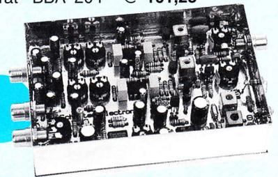
Die PLL 30 arbeitet mit 8 wählbaren Abstimmsschritten bis zu einer maximalen Frequenz von 2900 MHz, beginnend bei 250 MHz. Die Frequenzschritte betragen: 100 KHz, 200 KHz, 500 KHz, 1 MHz, 2 MHz, 5 MHz, 10 MHz und 20 MHz. Alle Einstellungen wie Mischer-Mode, Frequenz-Offset, Schrittweite, angezeigte Frequenz können gespeichert werden. Das beleuchtbare LC-Display zeigt neben der Frequenz auch die Schrittweite und die Lock/Unlock-Information an.
