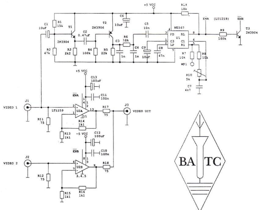
Videoinhalt wird entfernt. Hinter dem Hochpassfilter C3/R6/C4 bleibt das Horizontal-Synchronsignal 15625 Hz übrig und steuert die PLL NE567 an. Deren Freilauf-Frequenz wird ohne Eingangssignal mit R8 auf den Sollwert justiert, Kontrolle am Messpunkt MP1. Bei eingerasteter PLL geht Pin 8 auf logisch 0 und schaltet Eingang 1 durch. Wenn das Eingangssignal verschwindet, geht Pin 8 auf logisch 1 und schaltet Eingang 2 durch.
