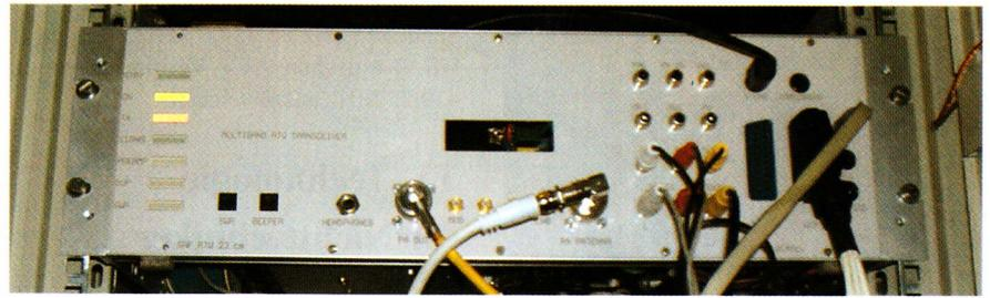
Bild 3: Herzstück des ATV-Relais: „ATV-Träger“ mit RX/TX Audio-/Videomatrix
