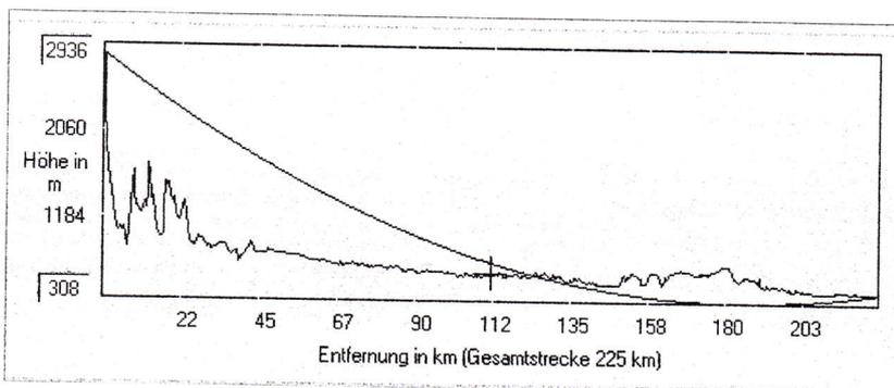
Geländeschnitt **mit** Einbeziehung der Erdkrümmung
