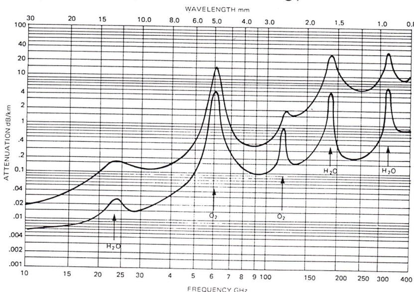
Wasserdampfabsorption bei den verschiedenen Frequenzen
