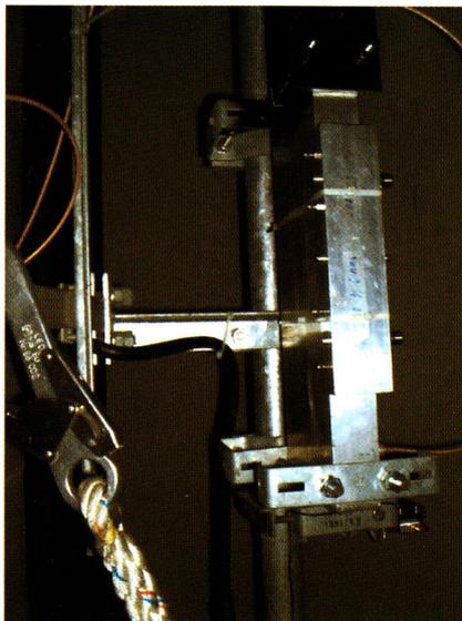
Bild 2: Der untere Teil der 23 cm-Ausgabeantenne mit Interdigitalfilter. Im Hintergrund der 10 GHz-Sender
