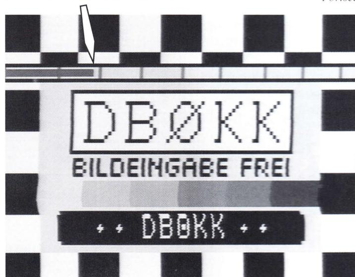
Hier ein Beispiel, wie die S-Meteranzeige im Testbild integriert werden kann. Im oberem Bild ist deutlich die vorhandene Rauschspannung bei fehlendem Eingangssignal zu erkennen. Zum Zeitpunkt der Aufnahme waren die Dioden im Eingang noch nicht vorhanden.
