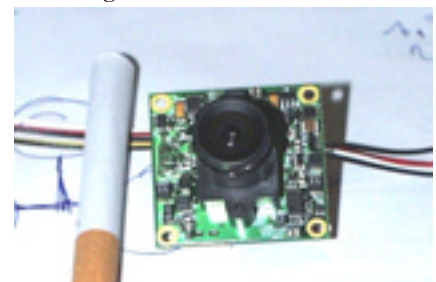
Das Farbkamera-Modul MTV.53KR10 ist nur 32 x 32mm klein bei voller PAL-Auflösung und stammt ebenfalls von lechner electric cctv
