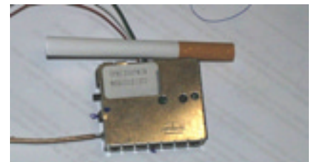
Der 23 cm FM-ATV-Sender von lechner electric cctv mit 50 mW, 4 Kanäle schaltbar, und 6,5 MHz Tonträger im Größenvergleich zu einer Zigarette. Gewicht ca. 40 Gramm
