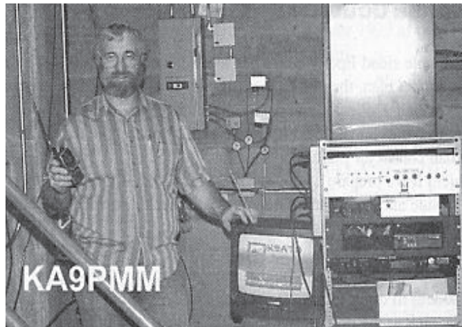
Antennen: 70 cm-Ausgabe 6 dB rundstrahlend horizontal, 23 cm-Eingabe Vertikal-Rundstrahler (Diamond), beide 36 m über Grund. Ausgangsleistung: 100 Watt auf 421,25 MHz VSB (Restseitenband).
