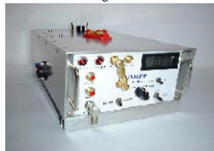
**24 GHz-Sende-Empfänger von DJ9PE (Eigenbau)**
