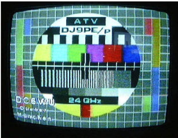
**24 GHz-Testbild, von DC6WU auf 10 GHz an DJ9PE zurückgesendet**
