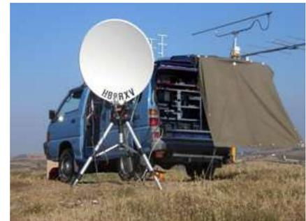
90cm-Offsetspiegel von HB9RXV bei IS/HB9IBC
