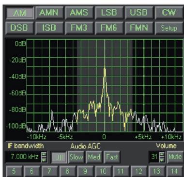
Audio-AGC-Einstellungen und stufenlose ZF-Bandbreiten-Wahl von 1 Hz bis 15 kHz. Optionale Filtereinstellungen heben die Empfindlichkeit auf bis zu 2 dB bei AM-, SSB- und FM-Betrieb und bis zu 10 dB bei CW an.
