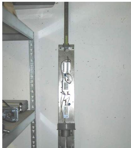
Sender Gesamtansicht DBØPTV: Sender, PA 1.Stufe, PA 2 Stufe gabz oben die 10GHz Schlitzantenne oberhalb der 2. PA-Stufe
