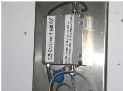
Die PA 2.Stufe 6 Watt out
