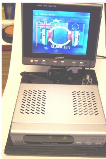
baut. Als Antenne diente eine Fensterklemmantenne aus dem C-Netz im 458 MHz - Bereich. Mittels der programmierten Frequenzen konnte das eingestellte Programm ZDF Dortmund Kanal 35 während der Fahrt auf der Autobahn A 1 einwandfrei bis 100 km/h Fahrgeschwindigkeit bis in den Raum Remscheid empfangen werden.
