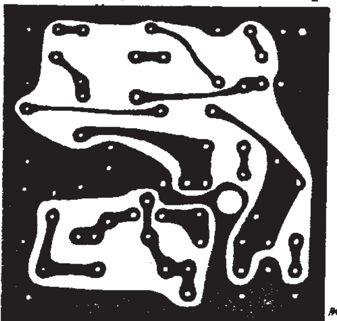
Abb.2: Die Leiterplatte für den Kabelsender im Maßstab 1:1
