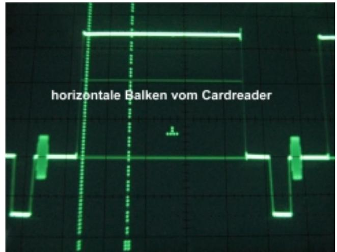
**Bild 3. Video aus dem Enhancer nach den Änderungen, aufgelöst nach Zeilenfrequenz**
