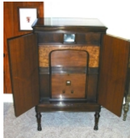
RCA 60-Zeilen-Empfänger von 1930 im Kino-Querformat, Sichtfenster am oberen Rand der eingebauten Nipkow-Scheibe
