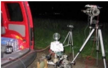
DJ1WF verwendete einen PIN-Diodendetektor mit 10 cm Sammellinse. Die Sichtverhältnisse waren mittelmäßig, also weder übermäßig klar noch sonderlich dunstig.
