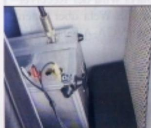
Der DATV-Sendekoffer hinter dem Pilotensitz
