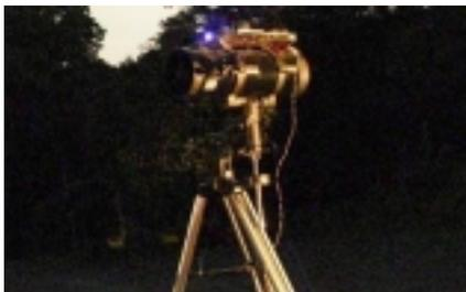
Am 18.05.200 wurde um 22.55 Uhr MESZ die bisherige Maximalentfernung von 11,1 km für Übertragungen mit einem violetten Laser nahe der Grenze zum UV-Licht nahezu verdreifacht. Das ist der momentane Rekord für Übertragungen auf 741 THz.
