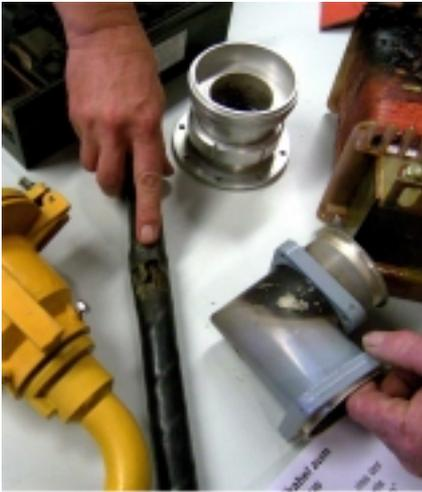
**Dicke Netzleitungen mussten die EVU schon bisher zu den Sendern verlegen. Im Bild eine in 1 Meter Tiefe vom Blitz getroffene und zerstörte Netzzuführung des Großsenders Grünen/Allgäu. Ein Mehrfaches an Energie und damit Kabel noch größerer Durchmesser würden bei DVB-T2 zu verlegen sein.**
