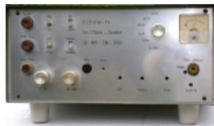
Eigenbau-AM-ATV-Station von DJ8DW 1966
