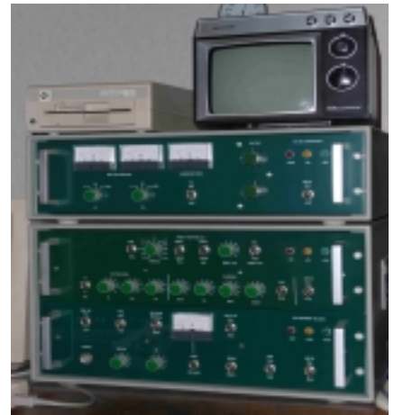
volltransistorisierten Eigenbau-Sender von Hans-Joachim Klein, DL2AD
