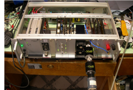
Während der Leistungsmessung auf dem Labortisch: TX 27 Watt
