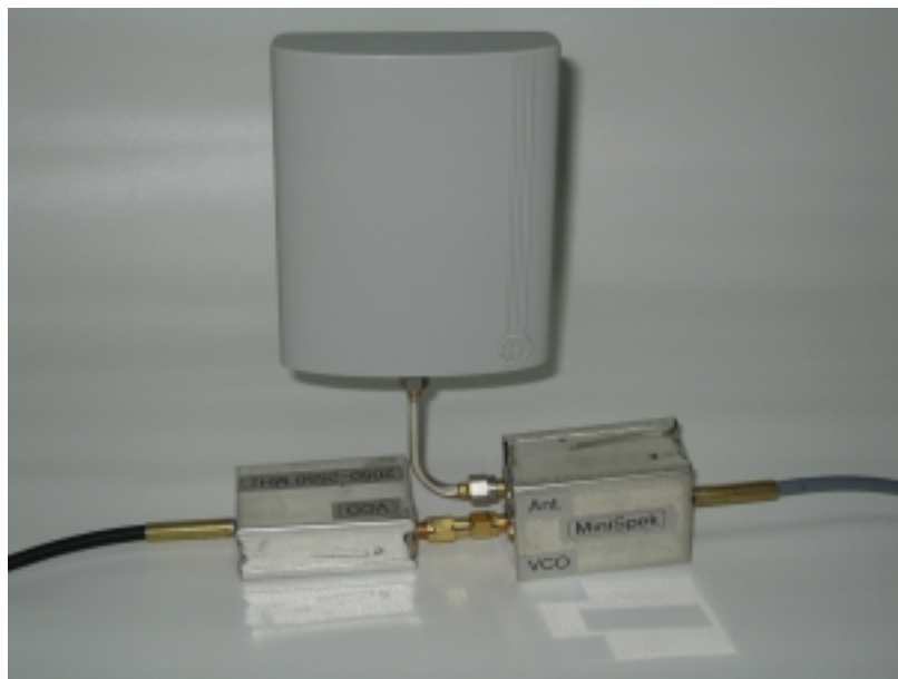
Bild 3: Messaufbau mit VCO, MiniSpek und WLAN-Antenne
