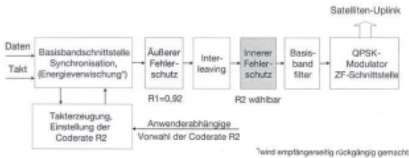
Bild 13.9 Sendeseitige Signalverarbeitung bei DVB-S
