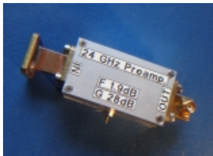
(B.7) Vorverstärker für Spiegelmontage vorbereitet
