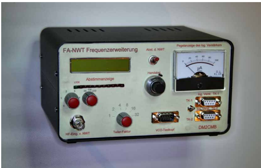
Geräteansicht „FA-NWT Frequenzerweiterung“. (Der zusätzliche Messeingang, „log.-Verstärker TK-1“ auf der Frontplatte, ist nur durch einen Eingriff in den FA-NWT realisierbar und wurde deshalb im Text nicht erwähnt.)
