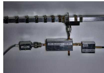
Bild 19: SWV-Messung an einer 13-cm-Yagi-Antenne
