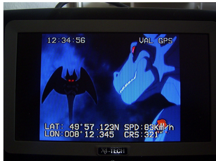
Abb. 4 Beispiel für die OSD-Bildschirmanzeige von GPS-Navigationsdaten
