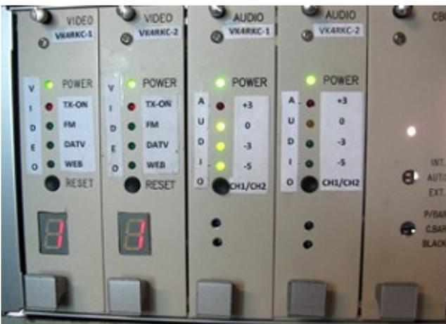
Die Nummer eines aktiven Eingangs wird über ein EPROM im 7-Segment-Display angezeigt.
