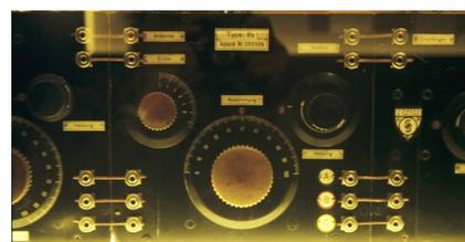
Radio in offener Modulbauweise („D-Zug“, Ausschnitt)
