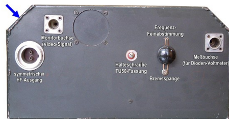
Bild 32 Frontseite des Senderbausteins Anschlußfeld für Antennenausgang, Meßbuchsen und Drehknopf für die Feinabstimmung der Senderfrequenz Blauer Pfeil: Schweißnaht
