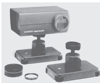
„video transfer“ Komplettsatz zum Heimgebrauch. Links stehend projiziert ein Schmalfilmprojektor auf die Mattscheibe der Kammer. Rechts blickt eine, auf dem Ministativ montierte Videokamera per Nahlinse und Spiegel auf die Mattscheibe. Foto: KAISER
