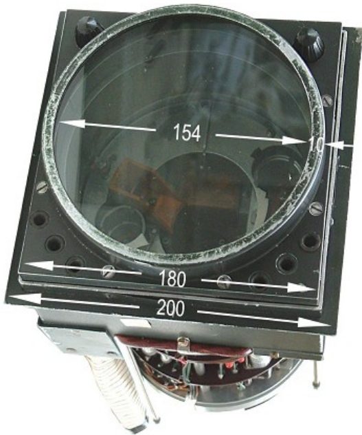
Bild 90 »Seedorf III«: Sichtfenster Maße des frontseitigen Abdeckkastens der Bildröhre
