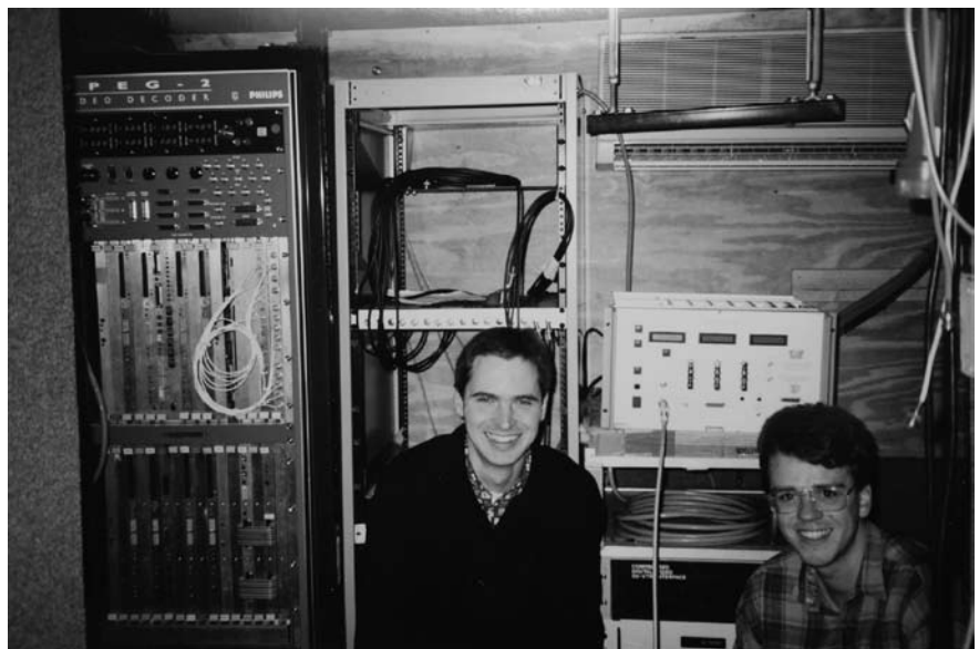
Adnan El Bardawil und Christoph Heiner, DL1EIN, im ATTC-Labor. Links: HDTV-MPEG-Decoderschrank, Mitte: Wuppertaler 8-VSB-Empfänger
