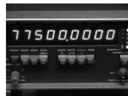
13: Zähleranzeige 77,5 kHz des Quarzoszsis, Reziprokzählung über 2. DCF-Zeitbasis
