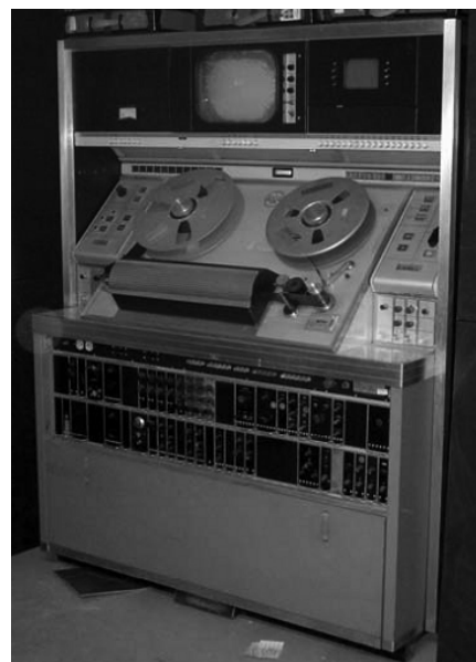
Schwarz/Weiß-Recorder RCA TR 22 Hersteller: RCA Radio Corporation of America, Baujahr 1965, Abmessungen: Höhe 180, Breite 141, Tiefe 68/49
