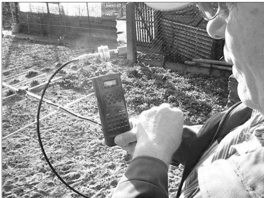
Das ist die Standard-Ausrüstung eines Radiosonden-Jägers: Empfänger mit Abschwächer (für das Nahfeld) und eine gute Peilantenne für den 405-MHz-Bereich. Fotos: DH3SUP
