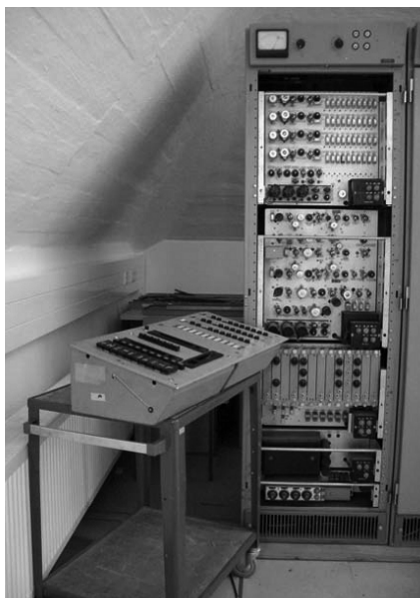
Bild-Trickmisch-Anlage RTM 20 A 08 Hersteller: Fernseh GmbH, Baujahr 1962, Abmessungen: Höhe 190, Breite 59, Tiefe 62
