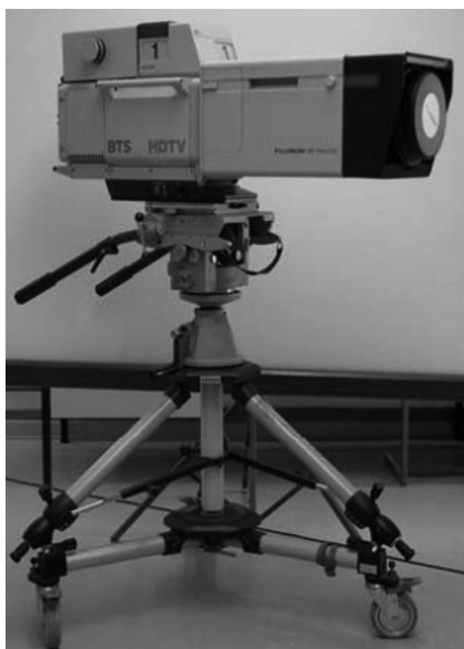
HDTV-Farbkamera KCH 1000 ("Vision1250" mit 1250 Zeilen)
