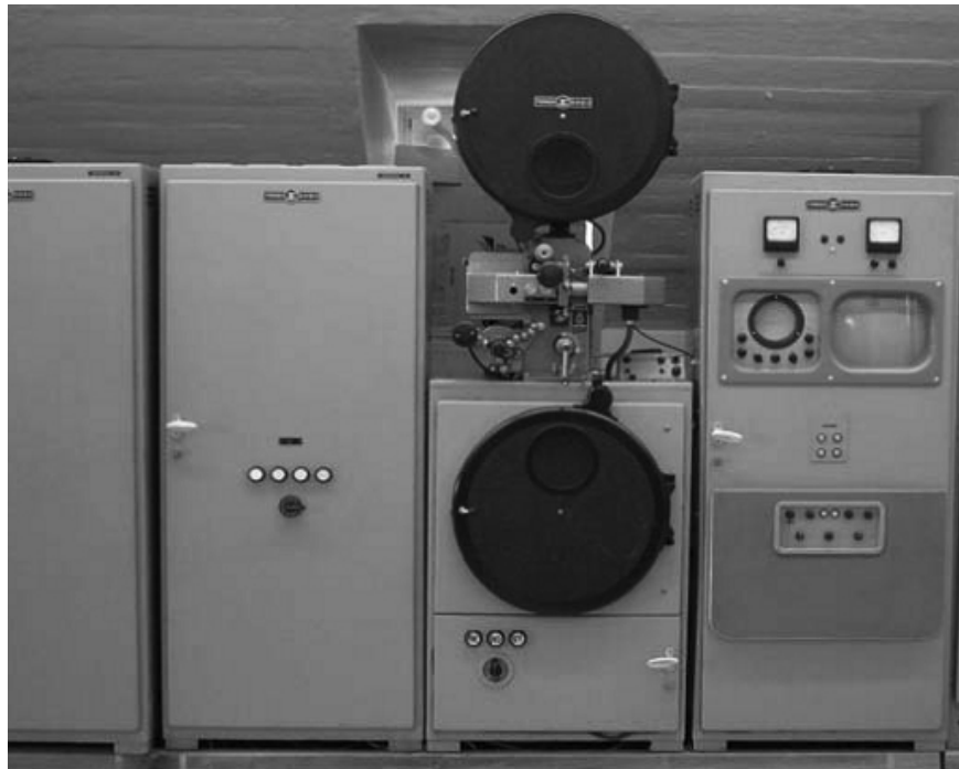
Film-Übertragungsanlage FAT / FVs 35 Hersteller: Fernseh GmbH, Baujahr 1956
