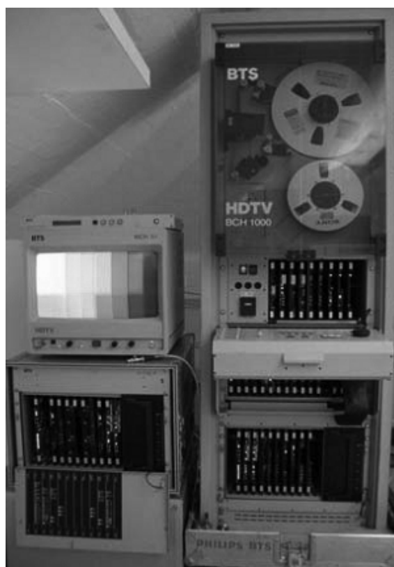
HDTV-Recorder BCH 1000, Hersteller: BTS Broadcast Television Systems, Baujahr 1989, Abmessungen: Höhe 176, Breite 60, Tiefe 92
