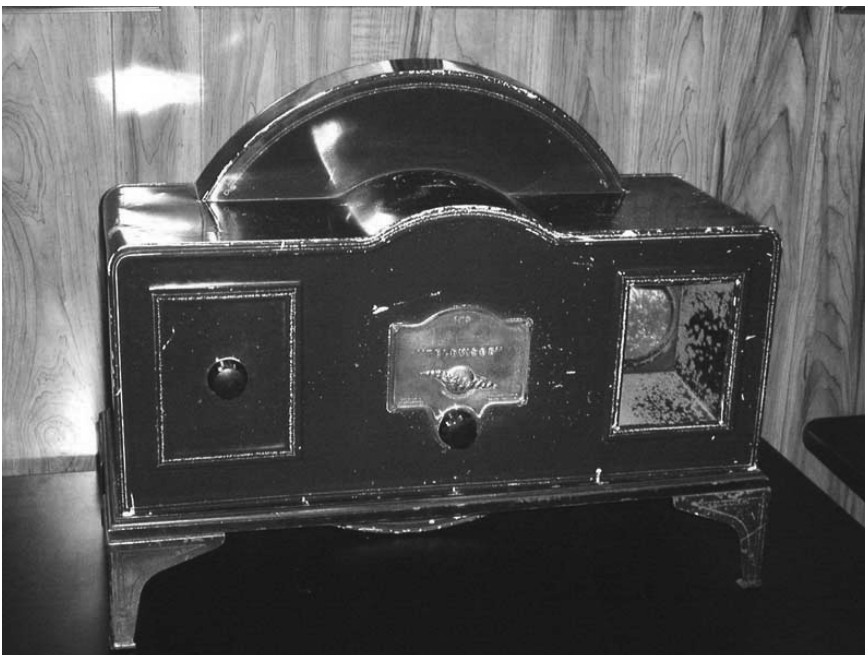
Original-Baird-Televisor von 1930, Nipkowscheiben-TV
