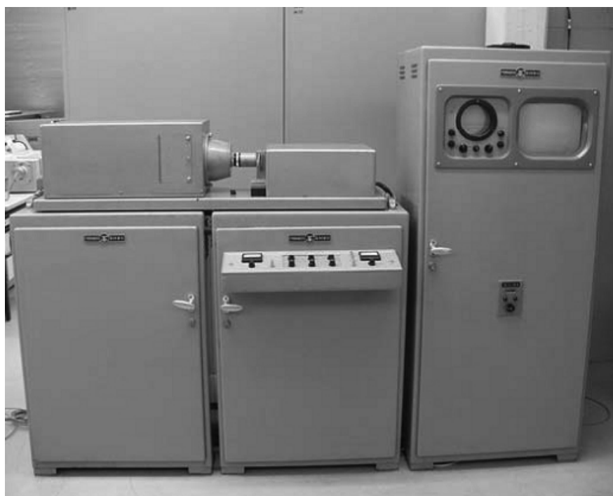
Schwarz/Weiß-Recorder RCA TR 22 Hersteller: RCA Radio Corporation of America, Baujahr 1965, Abmessungen: Höhe 180, Breite 141, Tiefe 68/49
