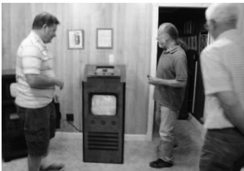
brit. TV-Gerät (15 Zoll-Bildröhre) von 1939
