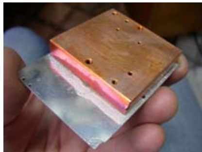
Leiterplattenunterseite mit verlötetem Kupferblock für leichtere Temperaturabzweigung
