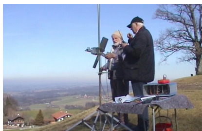
Günther und Schorsch senden zur Probe und melden die Winkelgrade an drei Empfangsstationen, die die Feldstärke notieren.
