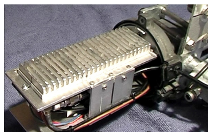
Die Wärmeabstrahlung erfolgt allein über die Konvektion der Kühlrippen und des Alu-Gehäuses.
