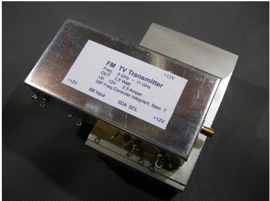
Fertig gebauter Sender hmc530+hmc952 im Weißblechgehäuse 11 x 55 mm mit eingebautem Frequenzcontroller mit 1-MHz-Schritten
