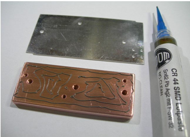
Lötpaste aufgetragen vor dem Verlöten, Platinenversion HMC530 mit HMC608
