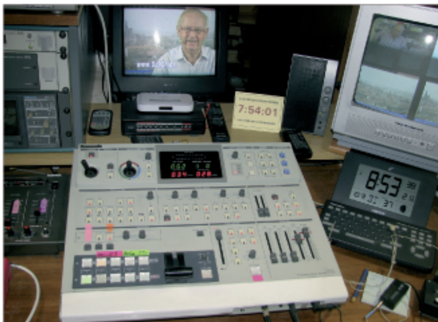
Die „Eurovisionszentrale“ bei DJ9XF: im Mittelpunkt der Videomischer, mit dem sich vier ATV-Signale in Bild und Ton mischen und zuordnen lassen.
