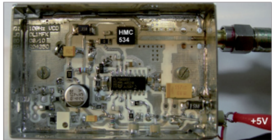
Testaufbau des FM-ATV-VCO mit HMC534
