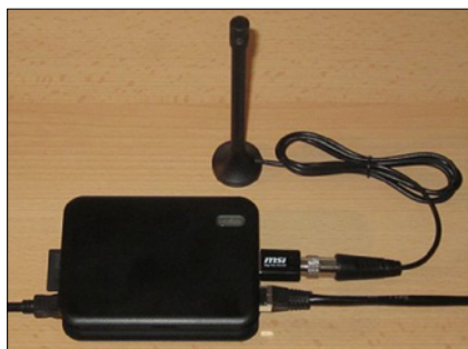
HAMServerPi: RaspberryPi mit DVB-T-Stick (z.B. für APRS-Empfang)
