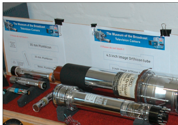
Links Plumbikon (Philips 1966), rechts Image-Orthicon (RCA 1954)
