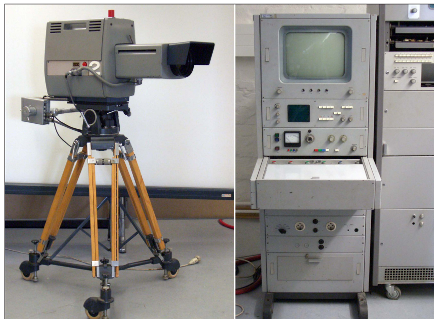
Die Farbkamera EL 8521 (links: Kamerakopf, rechts: Verstärker) ist voll transistorisiert und erstmals mit einer Zoom-Optik ausgerüstet. In den drei Farbkanälen (RGB) werden Plumbicon®-Röhren zur Erzeugung der Farbwertsignale verwendet. Der 1967 gebaute erste Farbübertragungswagen des WDR war bereits mit vier Kamera-Anlagen dieses Bautyps ausgerüstet.
