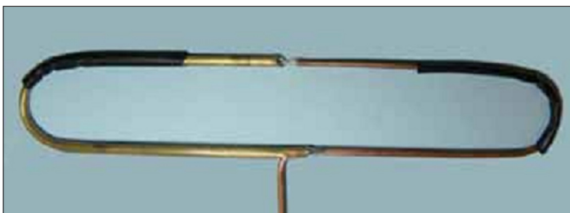
Eigenbau-Faltdipol für die Yagi-Antenne
