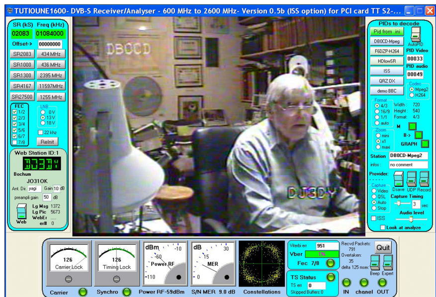
Bild oben: DATV-Spektrum 436 MHz GMSK mit DG0VE-Konverter, 1 Ms/s. Bild unten: Rückempfang von DBOCD in QPSK auf 434 MHz, Empfänger PCI-Karte TechnoTrend „S2-1600“ mit Tutioune-Programm von F6DZP.
