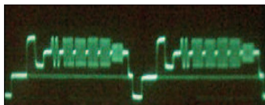
Abbildung oben: Comtech-TX-Multiburst - unten: Signal am Videoprozessor-Ausgang
