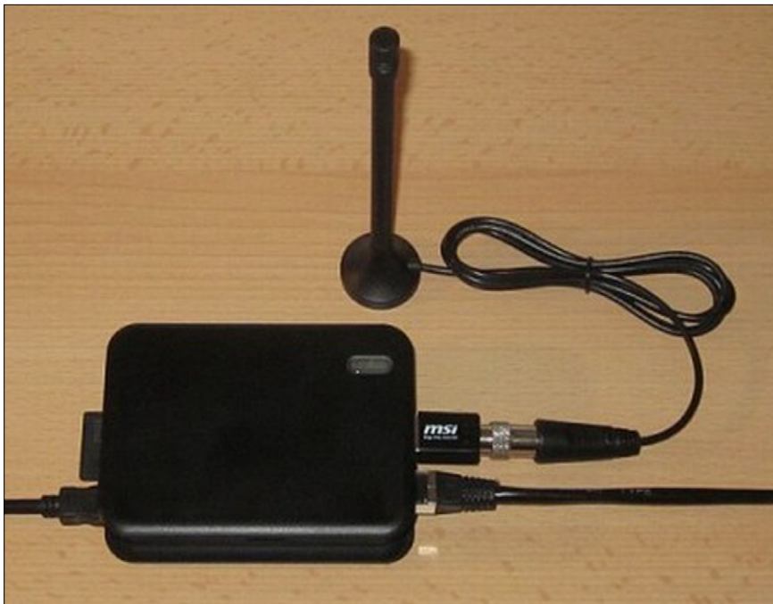
Raspberry Pi mit DVB-T-Stick (z.B. für den Betrieb als APRS-RX-Gateway)
