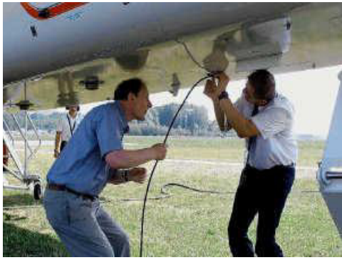
Uwe, DJ8DW, mit einem Piloten beim Anbringen der Sendeantenne am Zeppelin
