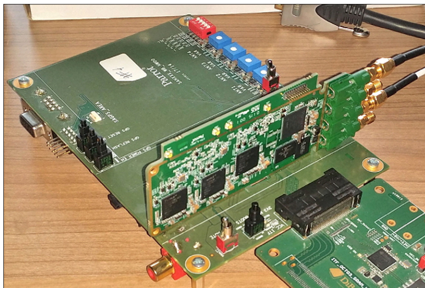
Laboraufbau eines Diversity-Testempfängers. Zwei von vier Antenneneingängen sind beschaltet.
