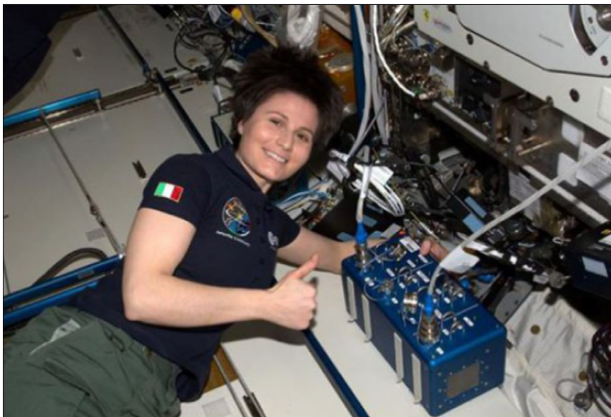
ESA-Astronautin Samantha, IZ0UDF, am blauen HamVideo-DATV-TX im Columbus-Modul der ISS
