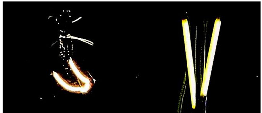
Links ein glühender Wolfram-Glühwendel, rechts ein fluoreszierendes LED-Filament.
