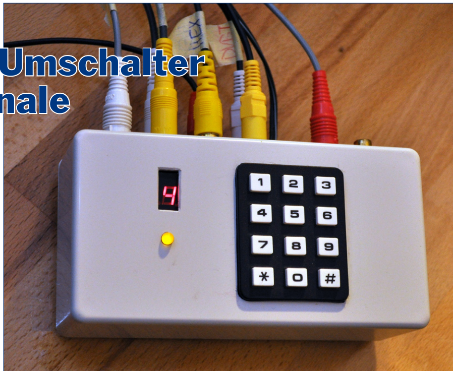
Der Video-Umschalter als Selbstbauprojekt mit Tastatureingabe und Kanalanzeige
