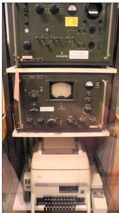
Empfangsanlage von Ende der 50er Jahre. Oben der FSE1300 demoduliert die RTTY-Signale, mittig der Kurzwellenempfänger E309, unten Blattschreiber mit Lochstreifenleser und -stanzer. Ein oben verbliebener, gelber Aufkleber nennt die Frequenzen für Wettermeldungen aus Moskau und Rom. Militärische Funker müssen Buchstaben und Ziffern auch unmittelbar aus dem Lochbild des gestanzten Streifens interpretieren können, und zwar 80 Zeichen/min vom 5er-Code.
