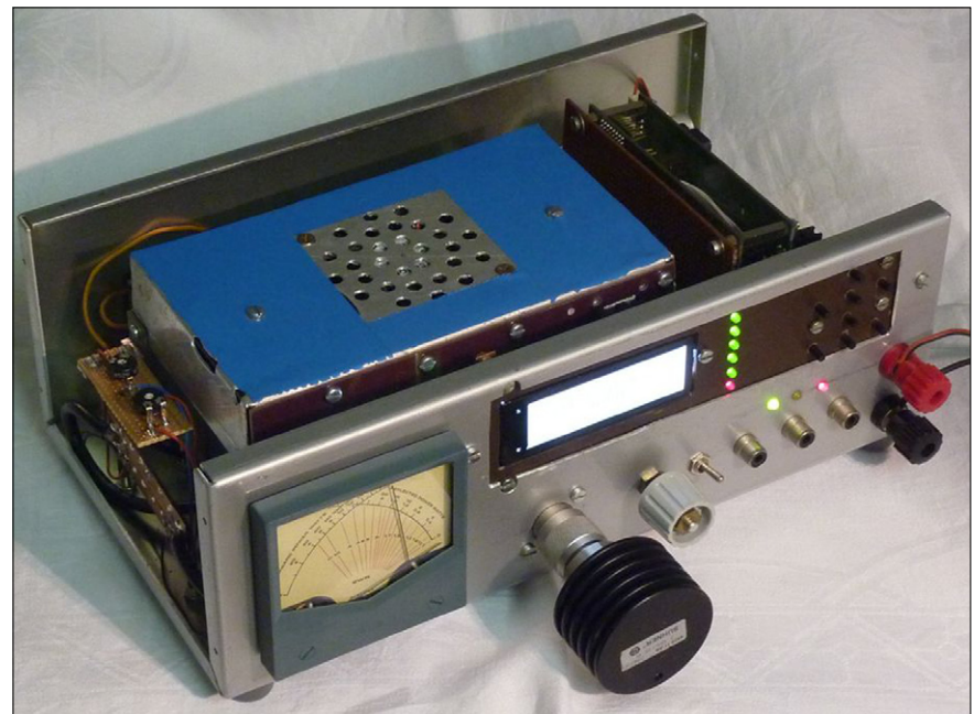
Gesamtansicht des 10-Watt-DVB-T-Senders von HB9 CSU mit Dummy
