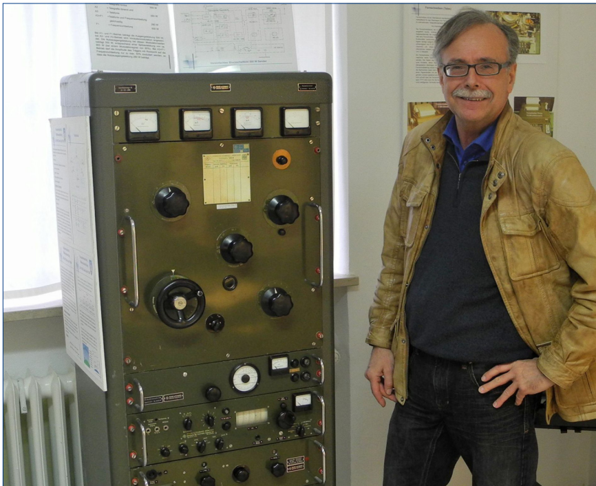
Den 500-W-Kurzwellensender SK 050 von Rohde und Schwarz, hier neben DH6MAV, gibt es gleich zweimal, in Haus 25 und A2.
