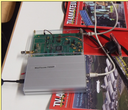
GMSK-Empfangs-Einheit von DJ3DY mit GMSK/QPSK-Konverter (DJ8DW)
