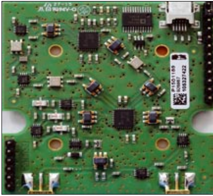
Bild 4: Leiterplatte von oben. Unten die Messbrücke mit dem Balun zur Signaleinspeisung, in der Mitte und oben die beiden VCO mit den Mischern.
