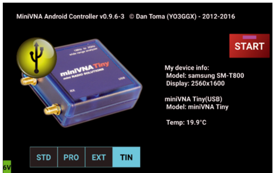
Bild 6: Eingangsbildschirm der App BlueVNA. Es wird angezeigt, dass das Samsung-Tablet mit dem miniVNA-Tiny über USB verbunden ist.
