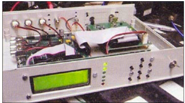
DVB-T-Empfänger von OE8EGK (SR-Systems-Platinen)
