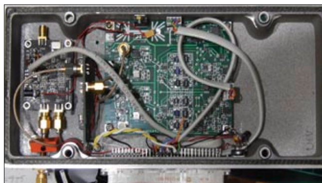
Portsdown-TX-Platinen im alten Gehäuse
