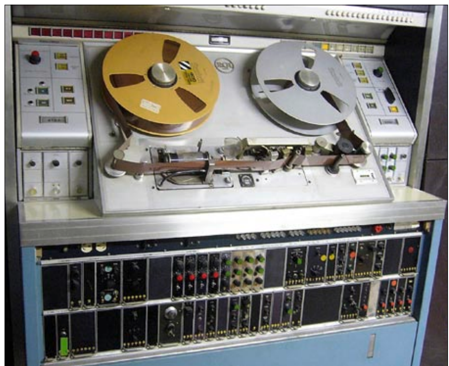
Die erste auf PAL umgebaute 2-Zoll-MAZ im histor. Farbfernsehlabor Univ. Wuppertal
