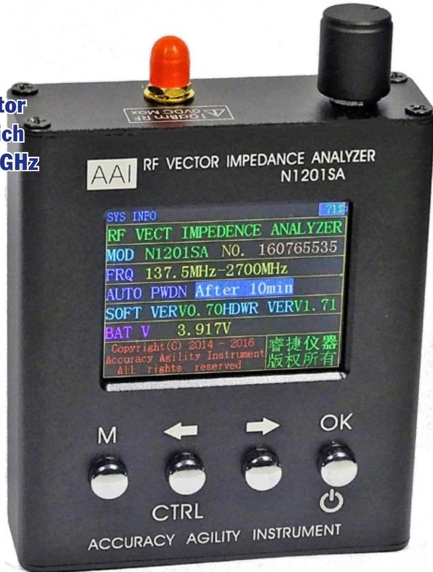
Bild 1: N1201SA, ein Antennen-Analysator für den Frequenzbereich von 140 MHz bis 2,7 GHz. Neben der SMA-Messbuchse befindet sich der Drehgeber zur Parameterauswahl.
