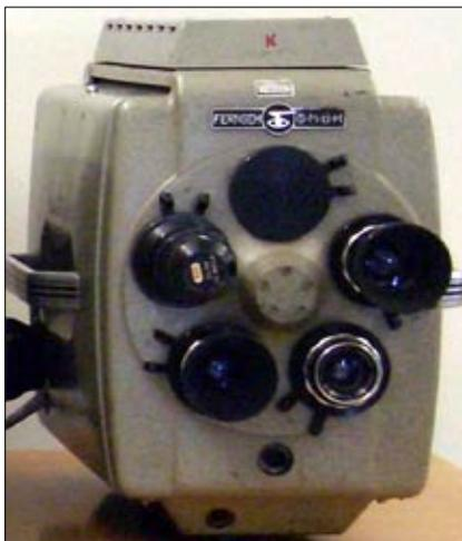
Objektivrevolver für Festbrennweiten
