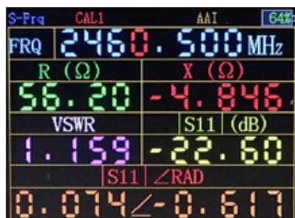
täts- und Induktivitätsmessungen umschalten. Die Scanfunktion ist wesentlich umfangreicher in der Darstellung und in den Einstellmöglichkeiten. Es können die Diagramme von fünf verschiedenen Scan-Parametern dargestellt werden. Das sind S11, VSWR, |Z|, R und X.
