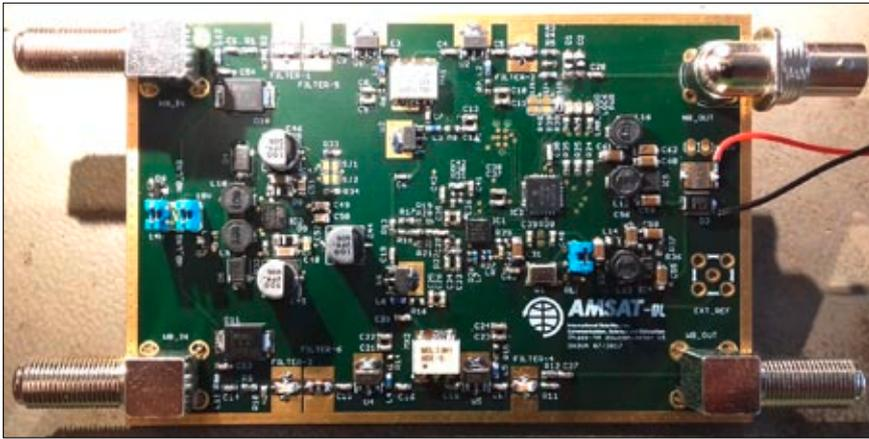
**Der AMSAT-Downconverter für Schmalband- und Breitband-Transponder.**
