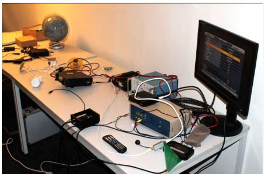
Testequipment während des Symposiums. U.a. zu erkennen sind FT817 mit 13-cm-Up-Converter, 10-GHz-RX-LNB, Duoband-Antenne für 10 GHz und 2,4 GHz, IC-706 als RX, Netzteile, MiniTiouner, SAT-RX, DATV-TX, LogPer-RX-Antenne, Kontrollmonitor.
