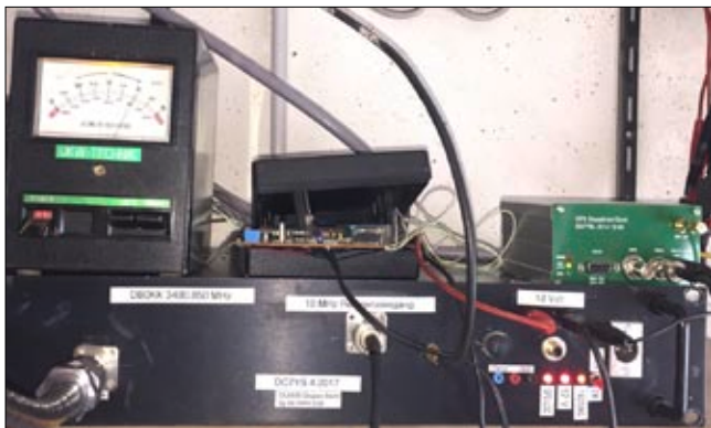
Gehäuse mit der 9-cm-Bake, GPS-RX-Rotorsteuerung und dem DTMF-Auswerter.
