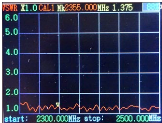
Die Abbildungen unten: links der gemessene VSWR-Verlauf, rechts die technischen Daten der beschriebenen Antenne ▶
