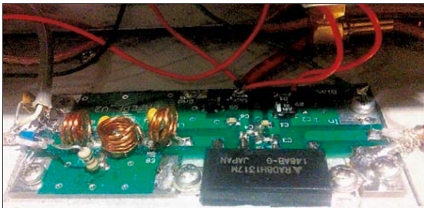
Bild 1: Rot isolierte Anschlüsse des HF-Detektors auf der PA-Platine oben
