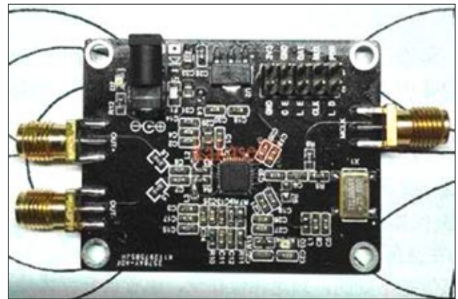
Bild oben: Der Aufbau des ADF4351-Lokaloszillator
