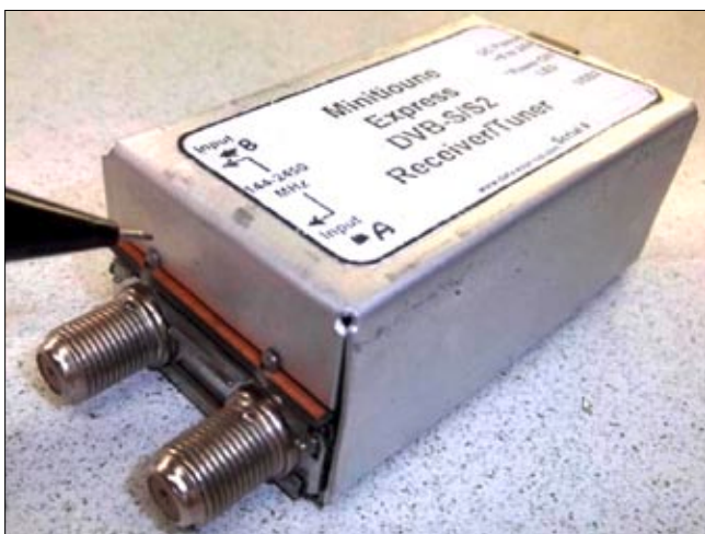
Prototyp des MiniTiouneExpress-Tuners
